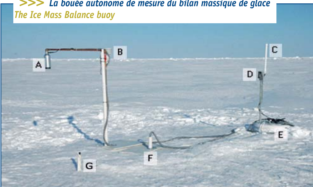
Figure 1. Système de mesure du bilan massique de la glace installé sur la banquise arctique.
