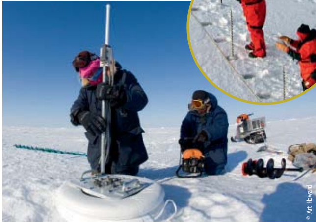
L'installation d'une IMB sur la banquise arctique par Jackie Richter-Menge et Bruce Elder. Jackie Richter-Menge and Bruce Elder installing an IMB in the Arctic sea ice cover.
